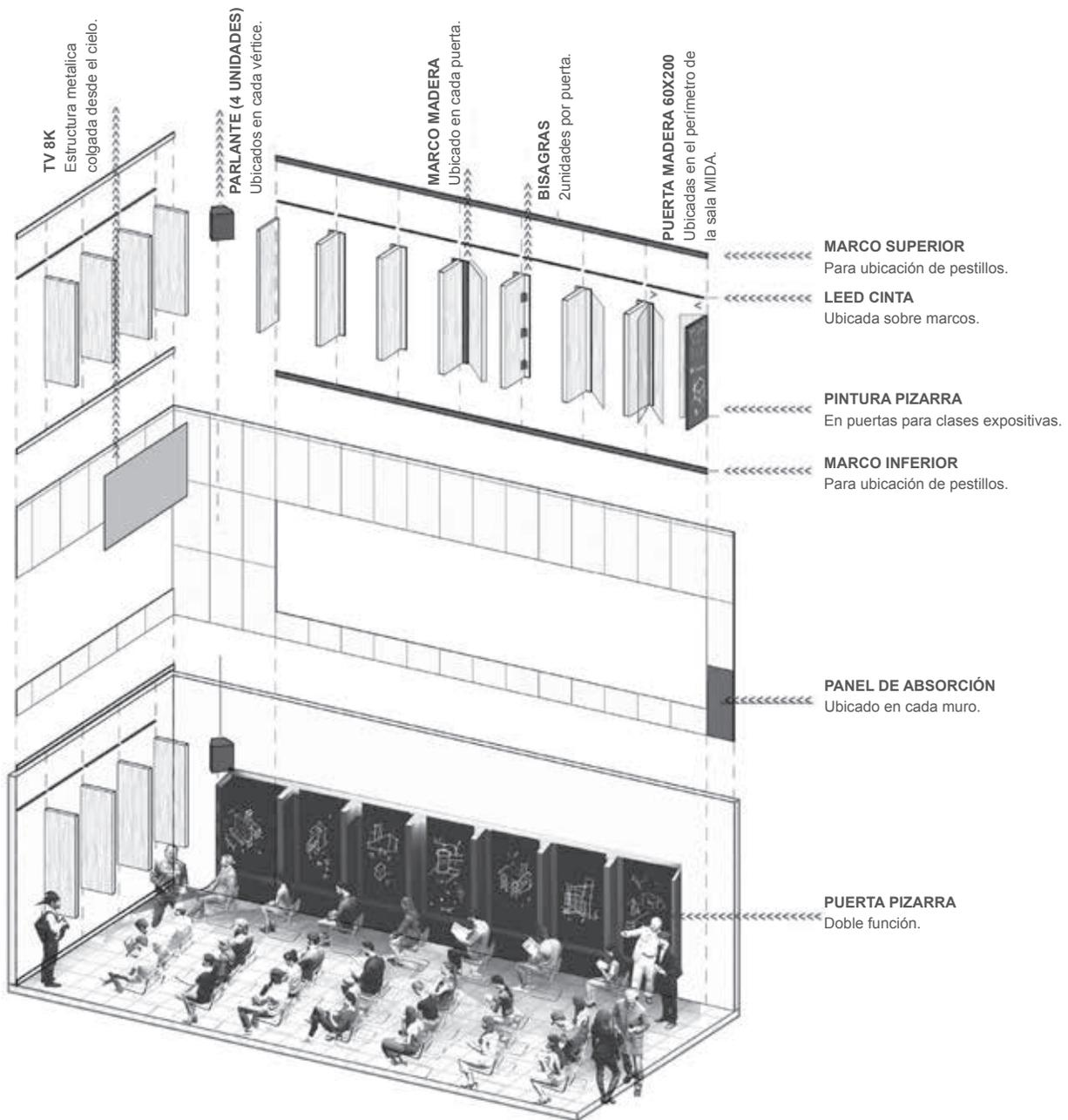
Figura 3. Axonométrica desplegada sala MIDA. Fuente: Elaboración propia.
